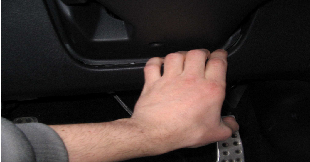
Figure 6. Tirer pour déclipser la garniture inférieure (partie centrale)
