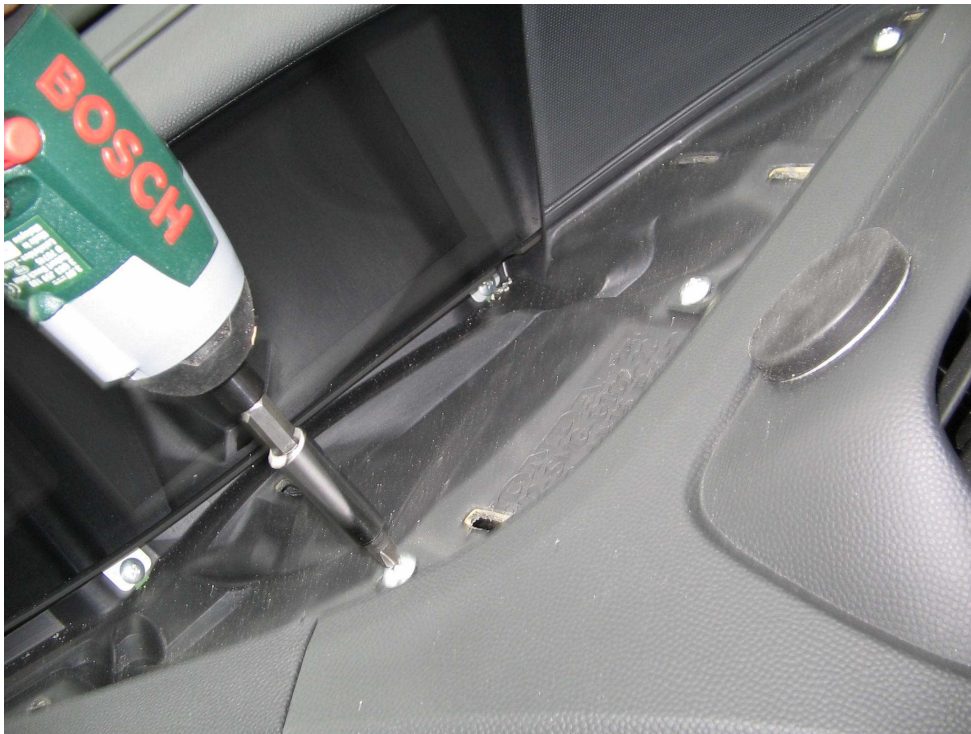
Figure 34. Dévisser les trois vis qui fixent l'autoradio par le haut
