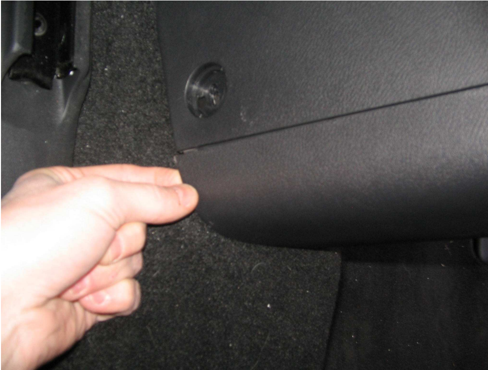
Figure 12. Détacher le fond d'accouoir
