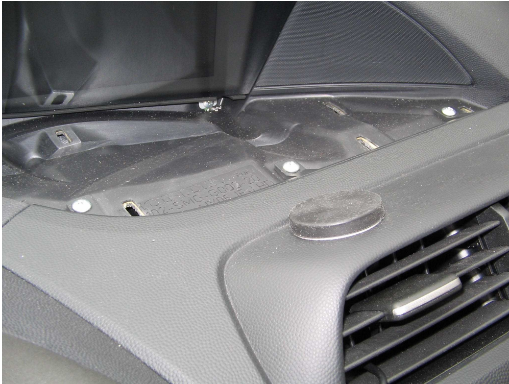
Figure 33. Vue des trois vis à démonter
