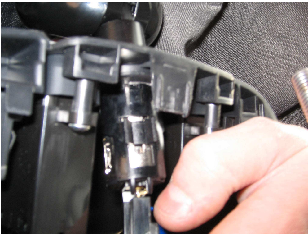
Figure 21. Débrancher la prise allume-cigare
