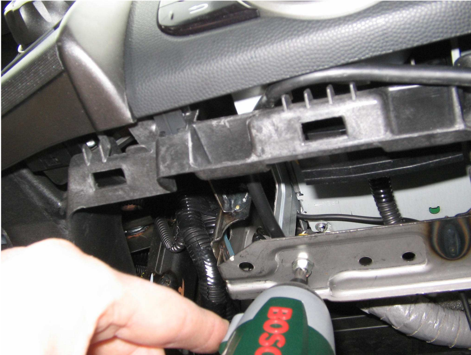
Figure 35. Dévisser les deux vis qui fixent l'autoradio de face
