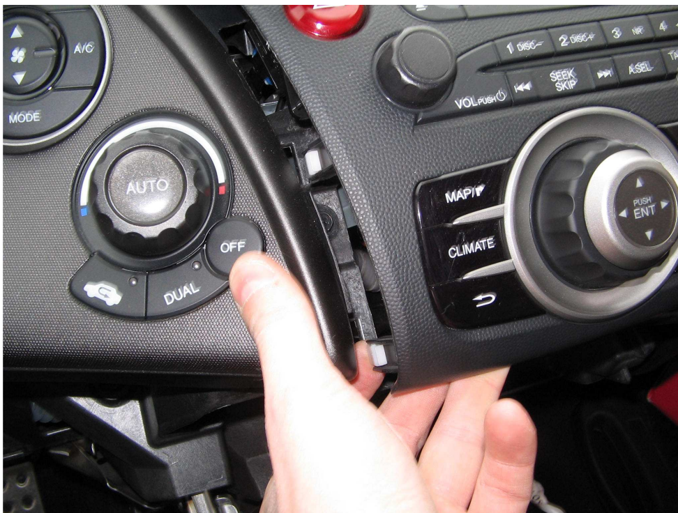
Figure 36. Déclipser l'autoradio en tirant un peu fort vers soi
