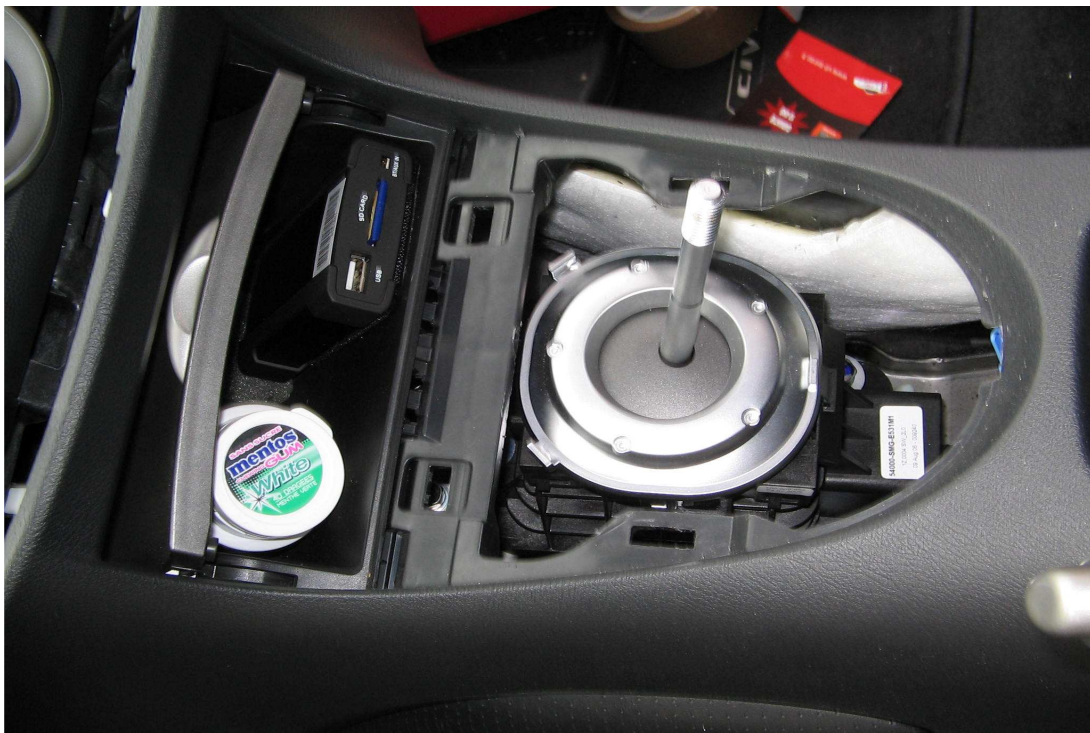
Figure 27. Vue du levier de vitesse à nu
