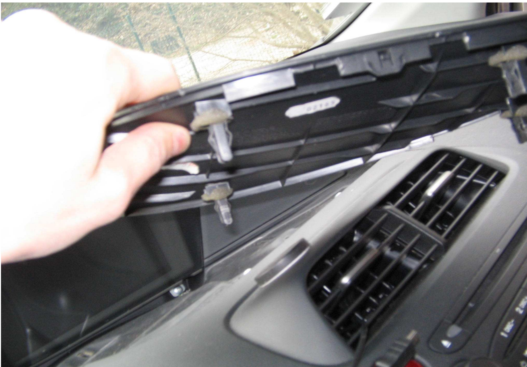
Figure 32. Oter la partie plastique
