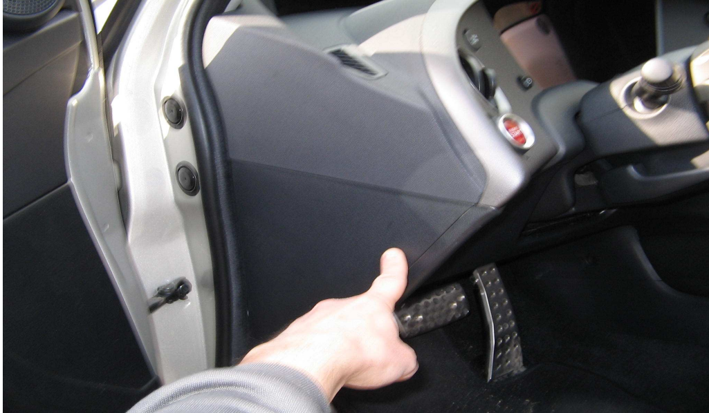
Figure 1. Localiser le plastique triangulaire près du démarreur
